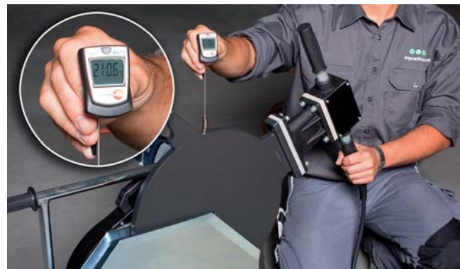
Hőmérséklet mérés green pipe®- tompa hegesztőgépen
