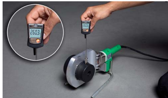
Hőmérséklet mérés green pipe®- Kézi hegesztőgépen (1400 W)
