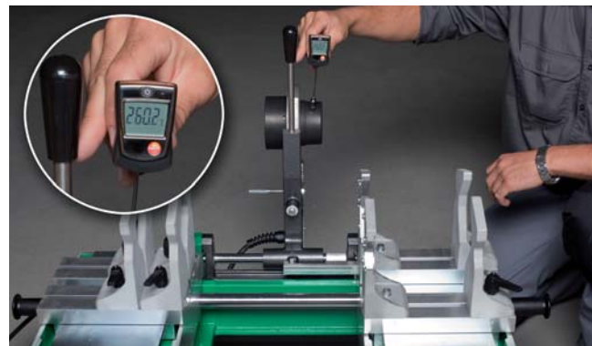
Hőmérséklet mérés green pipe®- hegesztőgépen
