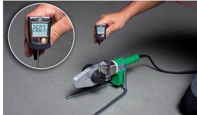
Hőmérséklet mérés green pipe®- Kézi hegesztőgépen (800 W)
